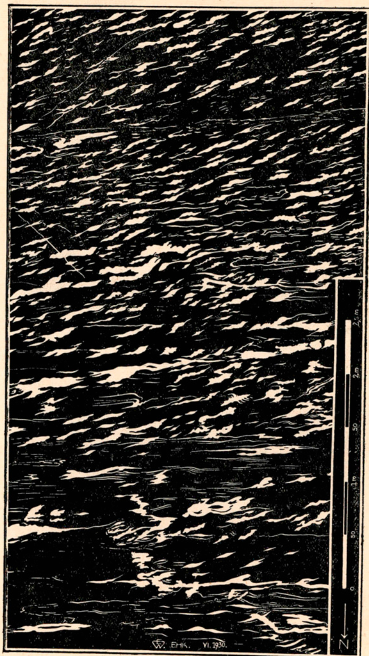
Secció d'una roca de Kamsholm (escala 1:95). — Negre = pissarra; blanc = venes de granitització (segons WEGMANN i KRANCE)
